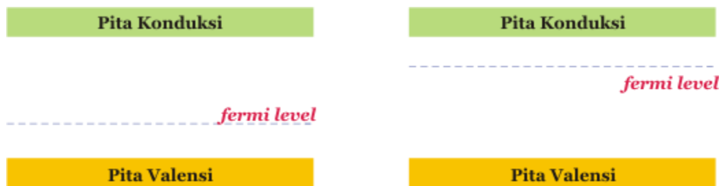
[Diagram pita energi semikonduktor tipe-p (kiri) dan tipe-n (kanan).]
